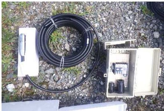
水位計 容量 20m 分解能 1.0cm
