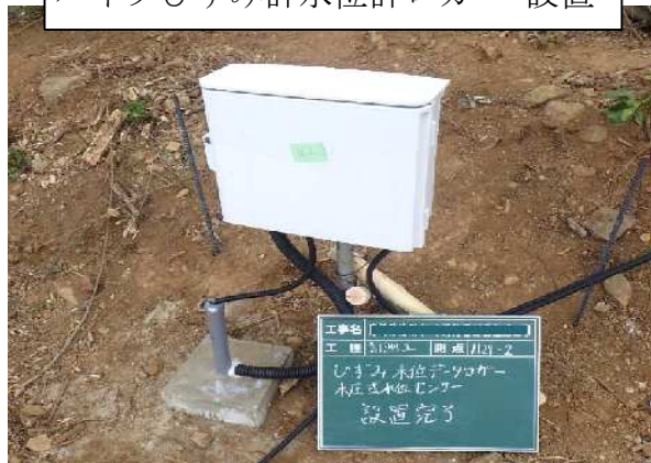
水位計 容量 20m 分解能 1.0cm
