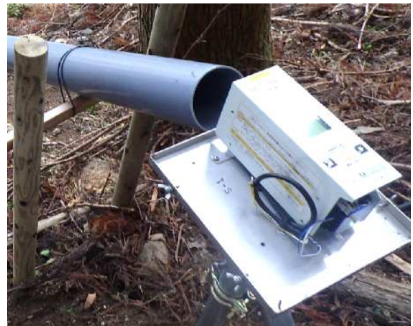
伸縮計 容量 1000mm 分解能0.1mm
