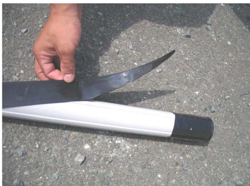
先端を斜めにカットする
